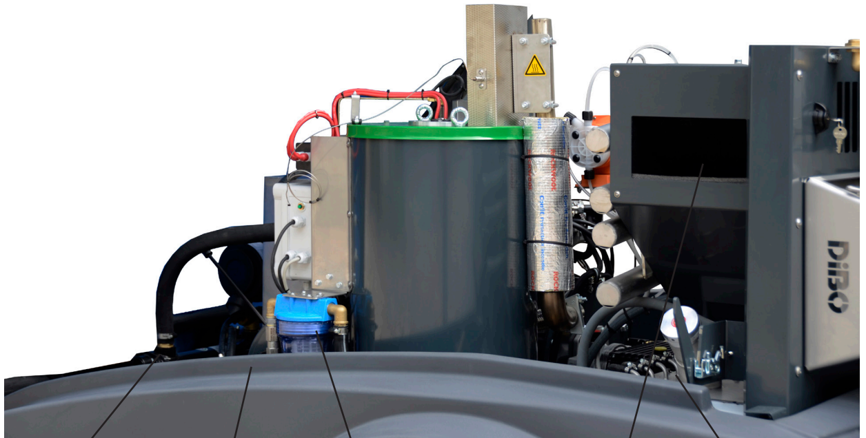
Échangeur de chaleur Réservoir d'eau Filtre d'eau de la pompe additionnelle Canal d'échappement Réservoir de carburant
